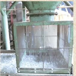
ペットボトルを破碎して再利用する。
