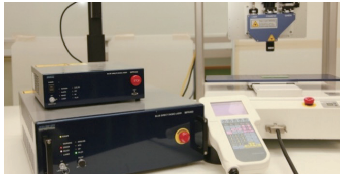
ロボットを組み込んだ半導体レーザ加工システム
