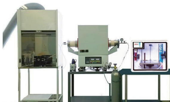
メタルデスク - EVO 316L：左からドラフトチャンバー、電気炉、3D プリンタ
