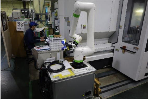
人が作業するときは片づけ可能なロボット
