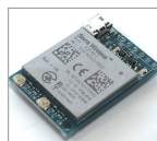
世界最小クラスの3G通信モジュール (GPS内蔵、アシストGPS機能対応) 3GIM V2.0 (株式会社タブレイン提供)
