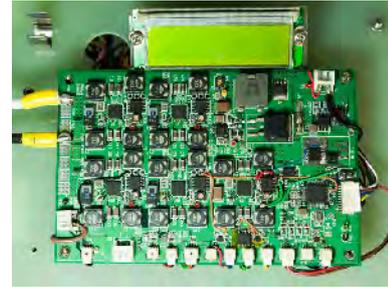
小型燃料電池制御基板
