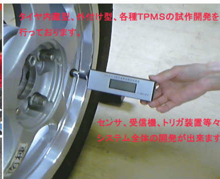
バルブ用ゴムキャップ内に圧力センサーが埋め込まれ、簡単に読み取ることが出来る。
