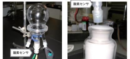
ブタンガスによる消炎実験      ドライアイス大気中の酸素濃度実験
